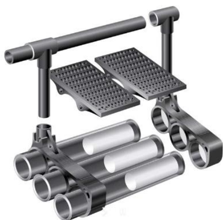
Joonis 6. HD315 sumbaraami konstruktsioon
